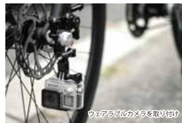
ヘッドライトのみならず、ウェアラブルカメラも取り付けられる、汎用性の高いハブランプホルダーです。ひとつで、3/8"、5/16" のハブ軸に対応する2WAY仕様。
